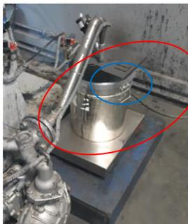
mélangeur est fermé hermétiquement. Il se compose d'une cuve avec un agitateur. Actuellement le remplissage s'effectue manuellement, dans un avenir proche l'alimentation se fera automatiquement.
